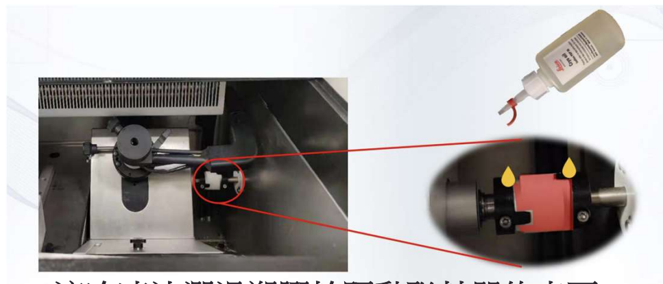
一滴冷凍油潤滑塑膠輪驅動聯軸器的表面
